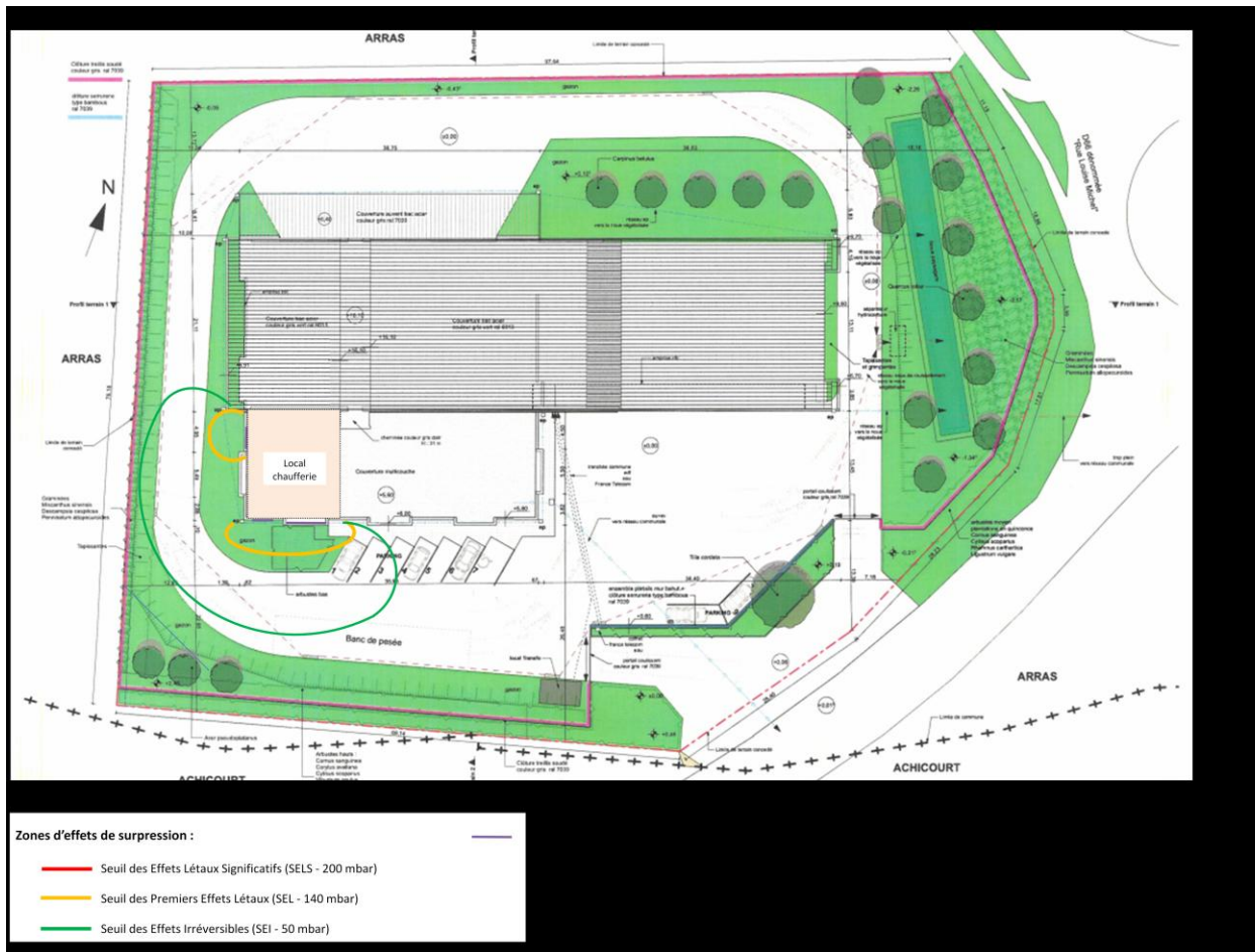
Figure 1 : Explosion du local chaufferie - Représentation graphique des zones d'effets de surpression
